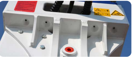
▲ Water jets for dust suppression (optional).
